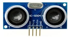
Fig: 2. Ultrasonic Sensor
